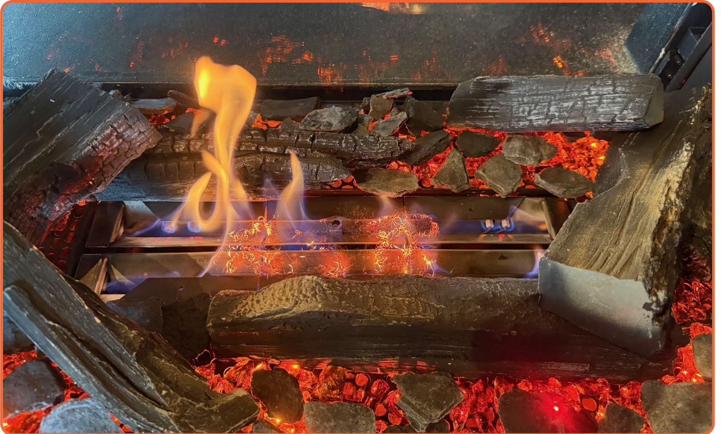
Füllen Sie den Rest mit schwarzen und grauen Chips auf. Achten Sie darauf, dass das Brennergitter ausreichend offen bleibt, damit Luft angesaugt werden kann.
