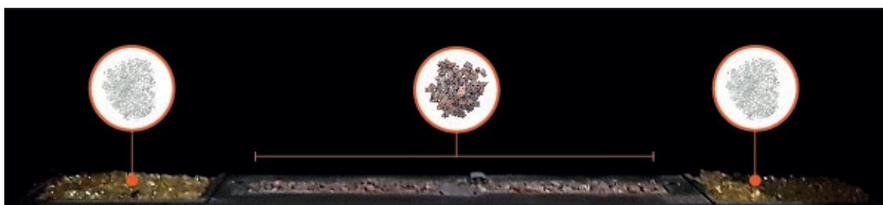
Plaats een laag lavastenen over de platte brander. Houdt de T-vormige gaten open voor een correcte ontsteking.
