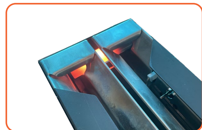
Afb. 4.5 PRIMING: brandstof wordt ontstoken
