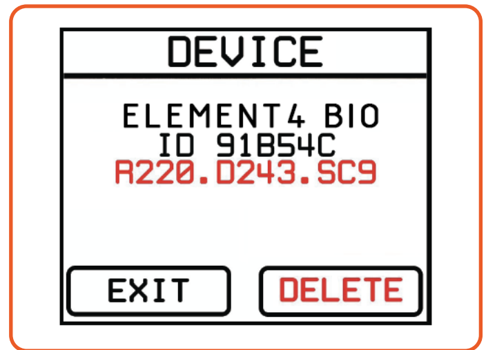
Figure 12.7 | Fehlercode wird auf der Fernbedienung angezeigt
