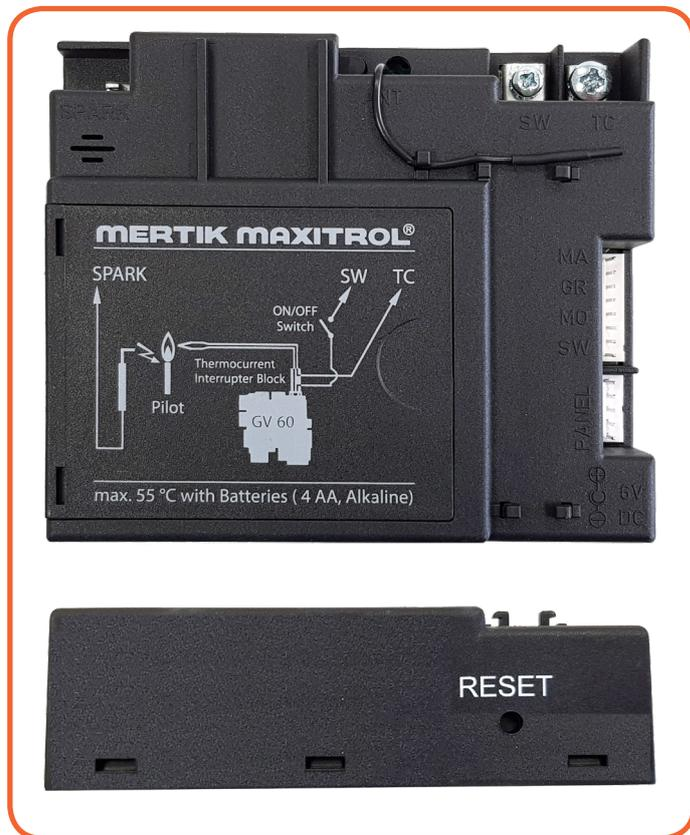
Abb. 4.2: Empfangsgerät (Drauf- und Seitenansicht)
