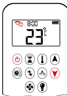
**EIN:** Drücken Sie zum Aktivieren gleichzeitig die Tasten und . wird angezeigt und die Fernbedienung wird funktionslos, mit Ausnahme der AUS-Funktion.
