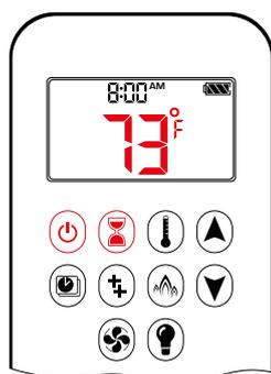
Drücken Sie gleichzeitig die Tasten und , um zwischen °C und °F zu wechseln.
